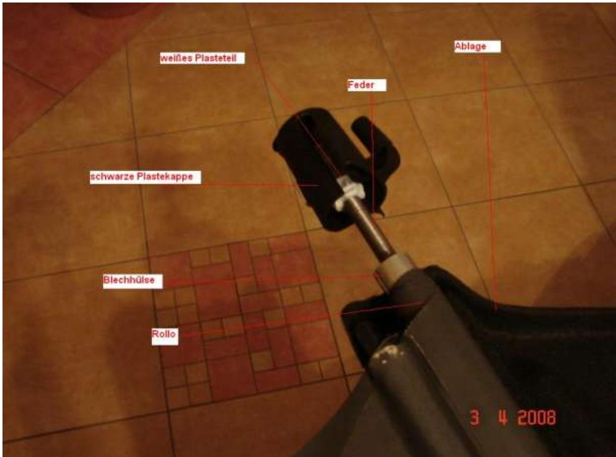
Schrauben rausdrehen, und das gesamte Rollo an der schwarzen Plastekappe von der Auflage nach oben abziehen. Rollo festhalten, und an der schwarzen Kappe mit leichten hin- und herbiegen kräftig ziehen. Irgendwann kommen die Innereien raus. Also die schwarze Kappe, ne lange Feder und unten dran ein weißes Plasteteil mit Aussparungen.
